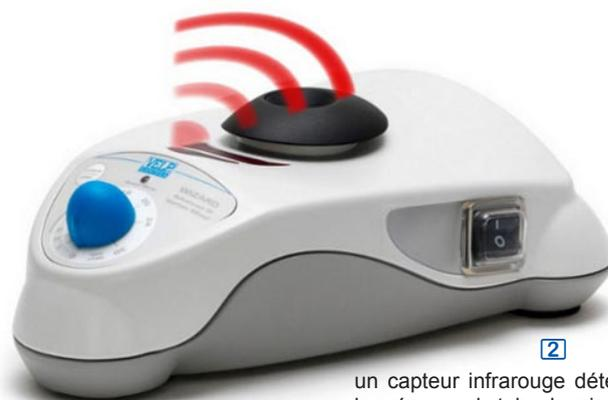
un capteur infrarouge détecte la présence du tube, la mise en service se fait ainsi instantanément sans effort manuel
