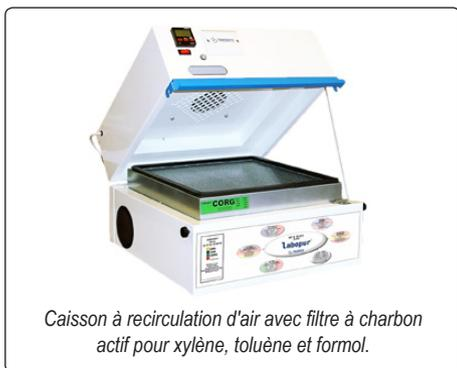
Caisson à recirculation d'air avec filtre à charbon actif pour xylène, toluène et formol.
