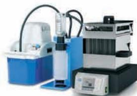
système complet pour piéger les gaz toxiques avec pompe aspirante et flacon piège (voir 554)
