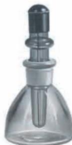
Cet ensemble est composé d'une fiole intérieure en verre teinté avec capuchon et tige permettant de prélever les gouttes d'huile à immersion et d'une fiole extérieure en verre blanc pour xylène.
