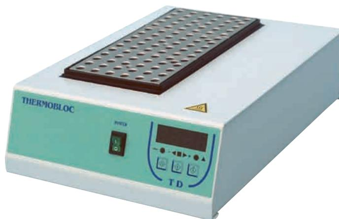
thermoblocs avec régulateur électronique et affichage digital (sans bloc)
