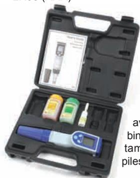
avec électrode combinée pH-température, tampon 4,00 et 7,00, piles
