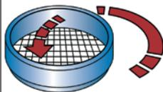
Le mouvement horizontal circulaire régulier assure une séparation précise du matériel à tamiser avec une granulométrie maximale de 63 mm. Ce mouvement s'avère idéal pour la séparation de certains produits comme les céréales broyées, les copeaux de bois etc.
