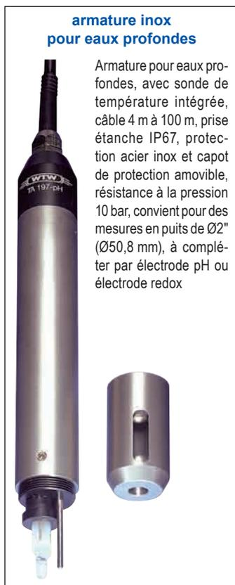
Armature pour eaux profondes, avec sonde de température intégrée, câble 4 m à 100 m, prise étanche IP67, protection acier inox et capot de protection amovible, résistance à la pression 10 bar, convient pour des mesures en puits de Ø2" (Ø50,8 mm), à compléter par électrode pH ou électrode redox
