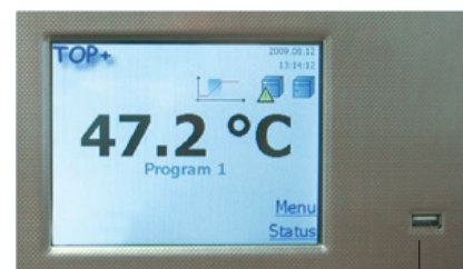
interface USB sur panneau frontal
