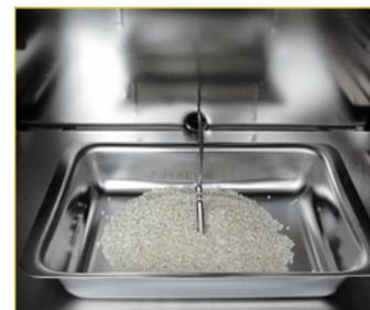
capteur de température directe sur les échantillons
