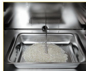
capteur de température directe sur les échantillons
