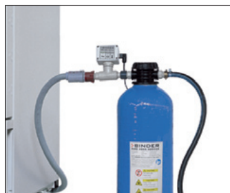
système d'alimentation en eau déminéralisée
