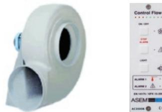
Les ventilateurs d'extraction sont livrés complets avec un système d'alarme pour le débit d'air, interrupteur de proximité et protection thermique du moteur. Le système d'alarme est relié à une sonde anémométrique montée dans la sorbonne, destinée à mesurer la vitesse de l'air. En cas de vitesse insuffisante, l'alarme s'enclenche.
