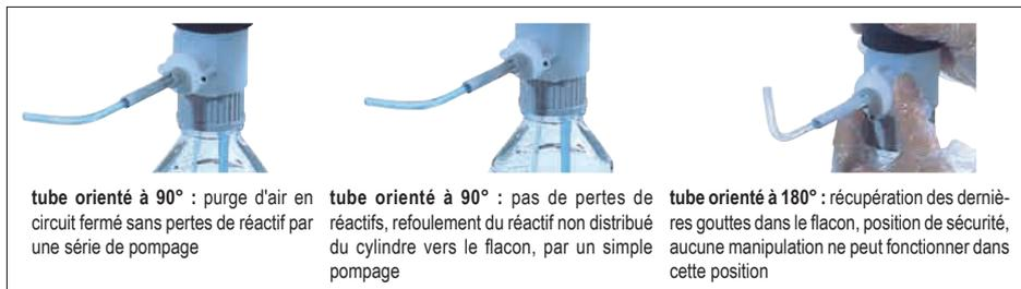
**tube orienté à 90°** : purge d'air en circuit fermé sans pertes de réactif par une série de pompage
