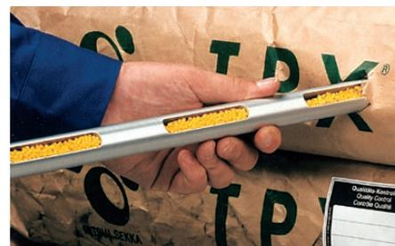
2 - ouvrir les chambres, puis retirer doucement le préleveur du sac; chaque chambre contient un échantillon provenant d'une zone de prélèvement déterminée
