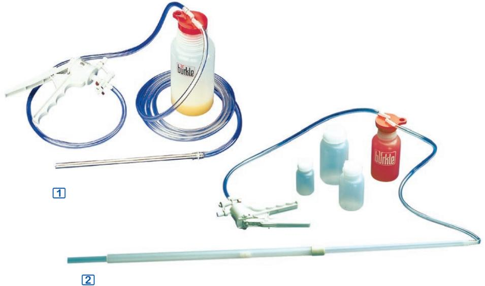
Ce dispositif de prélèvement est composé d'une canne en polypropylène ou d'un tube en acier inoxydable, et d'un tuyau en PVC relié à un flacon de prélèvement. Une **pompe manuelle** permet la création du vide dans le flacon, le prélèvement se fait ainsi par aspiration.
