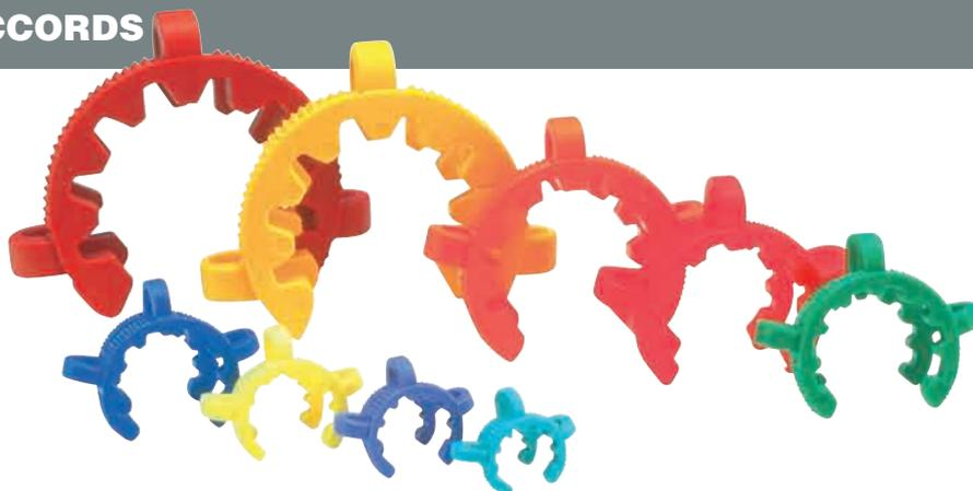
pinces en plastique pour raccords coniques codées en couleur (température jusqu'à 150°C)
