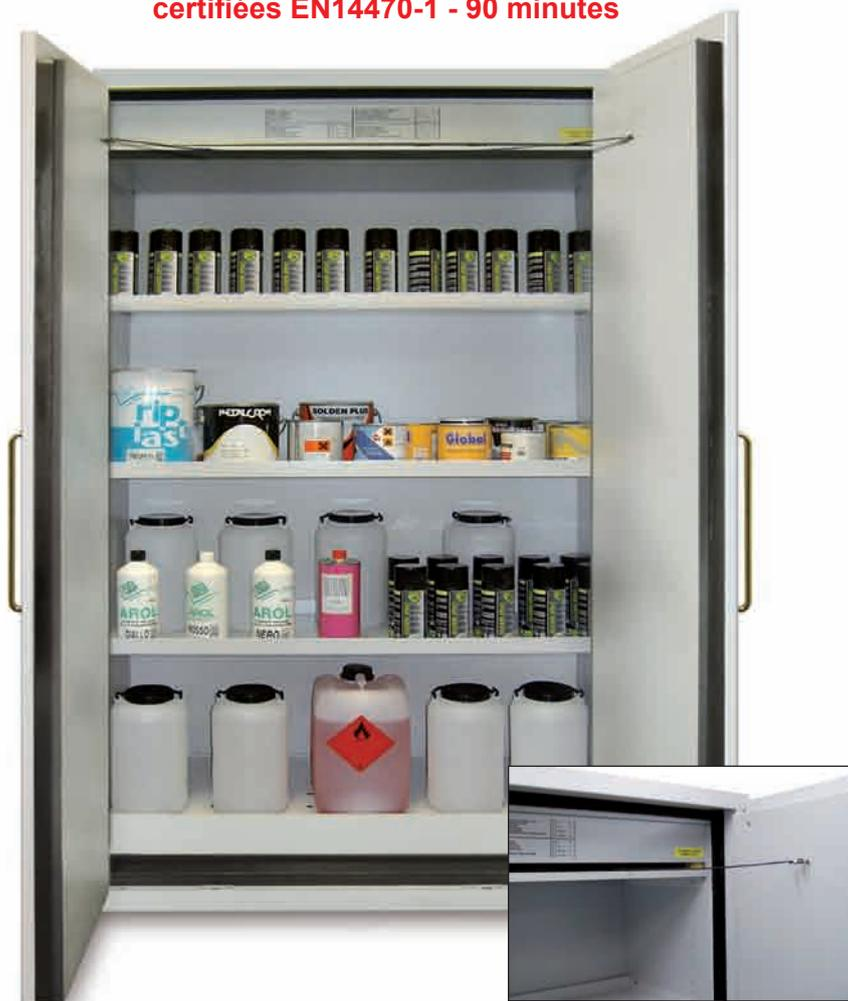
portes à fermeture manuelle, fermeture automatique en cas d'élévation de la température au-dessus de 50°C par thermofusible
