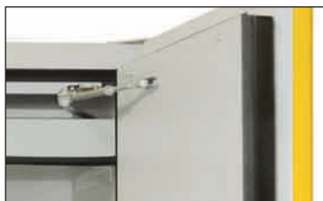
rappel automatique des portes, système de maintien de porte(s) ouverte(s) fermeture automatique en cas d'élévation de la température au-dessus de 50°C
