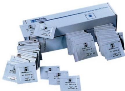
Le réactif spécifique à chaque détermination se présente sous forme de poudre conditionnée en sachet à usage unique prêt à l'emploi. Le réactif est prédosé. Certains dosages nécessitent un réactif sous forme liquide. D'autres dosages, tels que le Manganèse nécessitent la combinaison de réactif sous forme liquide et sous forme de poudre.
