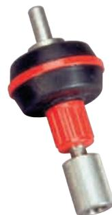
Cet accouplement sert au montage de tiges d'agitation en verre sur un moteur d'agitation. Il est monté directement sur l'arbre de l'agitateur (Ø 13 mm) et permet de recevoir des tiges Ø 5 à 10 mm
