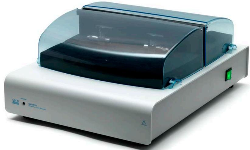
La réaction entre les composants sensibles d'un produit et l'oxygène est une des principales causes de l'altération de sa qualité. Cette réaction est une oxydation de certains composants de ce produit. En analysant la stabilité à l'oxydation d'un échantillon l'analyseur OXY1000 permet d'estimer la durée de conservation de l'échantillon.
