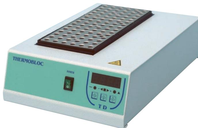
thermobloc avec régulateur électronique et affichage digital (sans bloc)
