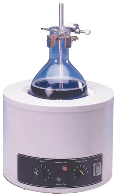
Ce chauffe-ballon permet de chauffer et d'agiter le contenu d'un ballon simultanément ou séparément.
