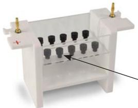
Tubes en verre pour le coulage du gel et le dépôt de l'échantillon. Ils sont déposés dans le module spécial pour électrophorèse 2D IEF (Isoelectric Focusing).
