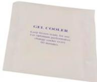
La mise sous tension augmente la température du tampon et ramolit le gel utilisé. Le sachet de refroidissement permet de contenir la montée de température lors de la migration.
