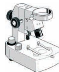
statif à bras télescopique, porte-objet blanc / noir ou transparent, réglage en hauteur de la tête, éclairage halogène 10 W, intensité réglable, éclairage par incidence avec filtre bleu, éclairage par transparence avec filtre dépoli blanc, (non compatible avec la tête XE5000)
