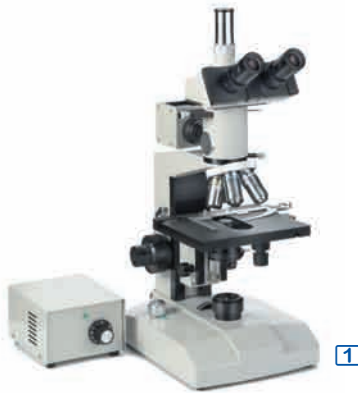
Microscopes métallographiques XE2800 (bino) et XE2810 (trino) objectifs SSM semi-plan IOS
