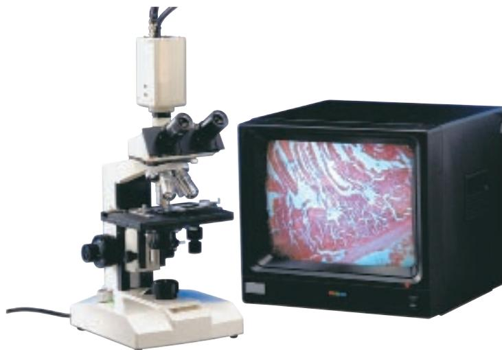
La caméra permet de filmer des images ou des expériences microscopiques, puis de les visualiser sur un écran, de les enregistrer sur magnéto ou de les imprimer.
