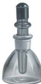
Cet ensemble est composé d'une fiole intérieure en verre teinté avec capuchon et tige permettant de prélever les gouttes d'huile à immersion et d'une fiole extérieure en verre blanc pour xylène.
