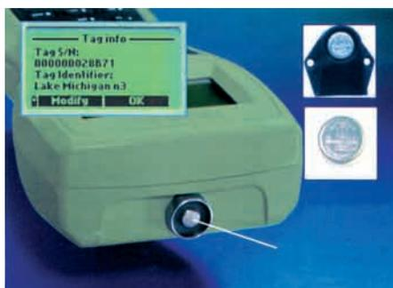
Le système FastTrack permet l'association automatique de la prise de mesures avec un lieu de prélèvement précis.
