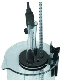
Constituée d'une bague en inox sur laquelle est fixée une mousse semi-rigide, percée de 5 trous : Ø 5, 6, 7, 10 et 15 mm.
