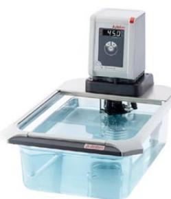
montage sur pont sur cuve polycarbonate
