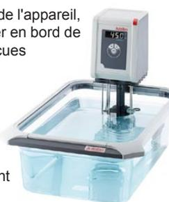
montage en bord de cuve polycarbonate
