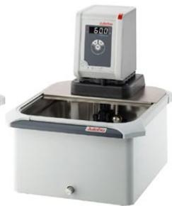
montage sur pont sur cuve acier inox
