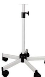
pied roulant télescopique lesté : en acier laqué, 5 roulettes, hauteur 600 à 1000 mm, Ø 53 mm (hauteur 900 à 1300 mm sur demande)
