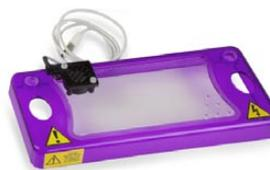
Bloc de ventilation intégré au couvercle de la cuve. Ce système permet d'empêcher l'apparition de condensation à l'intérieur de la cuve qui empêche d'observer la migration à travers le couvercle.
