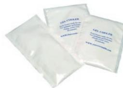
La mise sous tension augmente la température du tampon et ramolir le gel d'agarose. Le sachet de refroidissement permet de contenir la montée de température lors de la migration.
