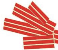
Le guide de dépôt se colle sur le support de gel au niveau des puits, pour une meilleure visibilité lors du dépôt de l'échantillon.
