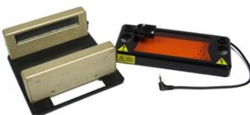
Bloc avec lumière bleue + couvercle avec filtre ambré et extracteur de condensation. Ce package permet de convertir les cuves à électrophorèse Mini et Midi en cuves avec lecture de la migration en temps réel.
