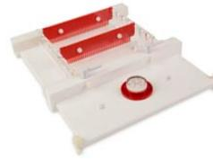
Le support de gel est déposé entre deux plaques de coulage dont l'espacement est réglé manuellement puis verrouillé avant coulage du gel. Permet de couler des gels de différentes tailles sans changer de plaque de coulage.
