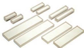
Blocs livrés par paires, à déposer dans la cuve. Ils permettent de réduire le volume occupé par la solution tampon dans le bac, de chaque côté des électrodes.
