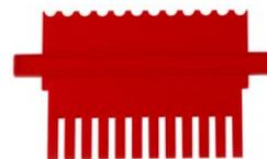
Le peigne se fixe entre les deux plaques de verre, après coulage du gel. Lorsque le moulage a pris forme, le peigne est retiré et laisse des puits formés dans le gel pour y déposer ses échantillons et marqueurs.
