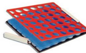
La cassette de transfert permet de positionner des éléments comme une mousse (fibre pads, en bleu sur cette image), un papier filtre, un gel et une membrane de transfert pour réaliser un électrotransfert.
