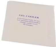
La mise sous tension augmente la température du tampon et ramolit le gel utilisé. Le sachet de refroidissement permet de contenir la montée de température lors de la migration.
