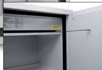
portes à fermeture manuelle, fermeture automatique en cas d'élévation de la température au-dessus de 50°C par thermofusible
