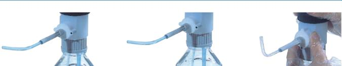
tube orienté à  $90^\circ$  : purge d'air en circuit fermé sans pertes de réactif par une série de pompage
