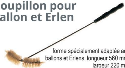
forme spécialement adaptée aux ballons et Erlen, longueur 560 mm, largeur 220 mm
