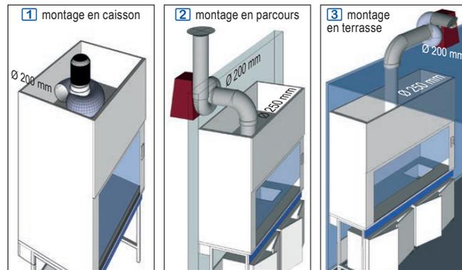
Moteurs centrifuges livrés complets avec chaise de montage
