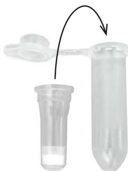
Pour la filtration, l'ultrafiltration et la purification de biomolécules
