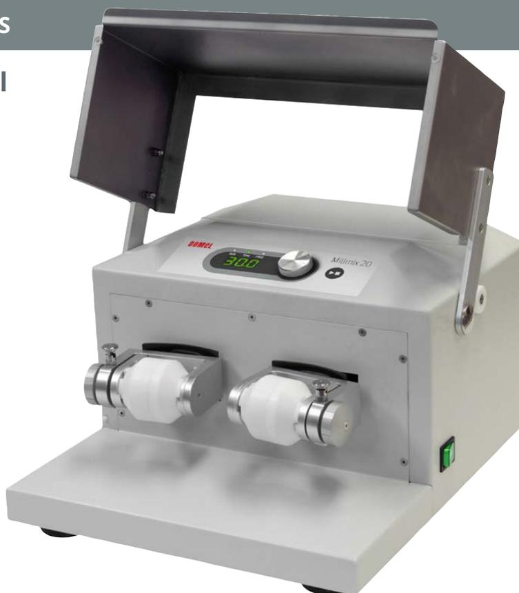
Broyeur basé sur le principe du bol + billes pouvant recevoir jusqu'à 2 bols indépendants soumis à un mouvement tridimensionnel à amplitude réglable.
