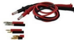
Électrodes positive et négatives, à brancher sur chaque extrémité de la cuve à électrophorèse et sur le générateur.
