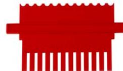
Le peigne se fixe entre les deux plaques de verre, après coulage du gel. Lorsque le moulage a pris forme, le peigne est retiré et laisse des puits formés dans le gel pour y déposer ses échantillons et marqueurs.
