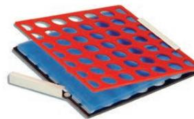
La cassette de transfert permet de positionner des éléments comme une mousse (en bleu sur cette image), un papier filtre, un gel et une membrane de transfert pour réaliser un électrotransfert.
