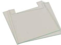
Cette plaque s'insère dans le module de migration, en parallèle avec la plaque de verre pleine (ci-contre). La partie découpée permet d'insérer un peigne, ou le gel issu de l'IEF (focalisation isoélectrique).
