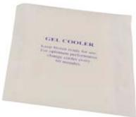
La mise sous tension augmente la température du tampon et ramolli le gel utilisé. Le sachet de refroidissement permet de contenir la montée de température lors de la migration.
