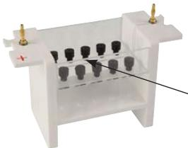
Tubes en verre pour le coulage du gel et le dépôt de l'échantillon. Ils sont déposés dans module spécial pour électrophorèse 2D IEF (focalisation isoélectrique).
