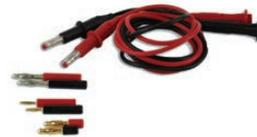
Électrodes positive et négatives, à brancher sur chaque extrémité de la cuve à électrophorèse et sur le générateur.
