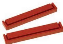
Livrées par paires, les plaques de coulage s'emboîtent dans les extrémités du support de gel pour créer un récipient dans lequel le gel sera coulé.
