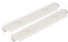
Le peigne se fixe à ses extrémités sur le support de gel. Lorsque le moulage a pris forme, le peigne est retiré et laisse des puits formés dans le gel pour y déposer ses échantillons et marqueurs.
