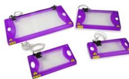
Bloc de ventilation intégré au couvercle de la cuve. Ce système permet d'empêcher l'apparition de condensation à l'intérieur de la cuve qui empêche d'observer la migration à travers le couvercle.
