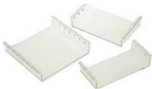
Support pour mouler le gel et insérer les peignes. Le support avec le gel rigide est déposé dans la cuve à électrophorèse et recouvert par un liquide tampon.
