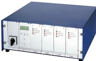
Le générateur ultrasonique transmet les oscillations électriques hautes fréquences aux transducteurs piézoélectriques qui transforment ces oscillations en oscillations mécaniques ultrasoniques. Le générateur et les transducteurs sont reliés par un simple câble haute fréquence. Le choix du générateur se fait en fonction du nombre d'éléments piézoélectriques utilisés.
