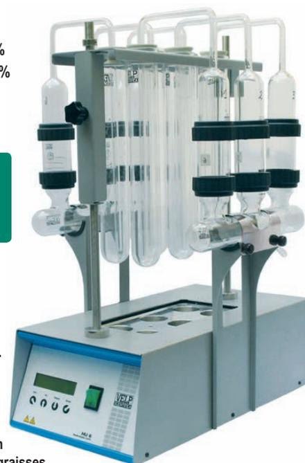
La graisse est souvent naturellement ancrée dans la matière alimentaire rendant son extraction difficile. Cette unité permet l'hydrolyse, la filtration et le lavage d'un échantillon alimentaire afin de rendre les graisses accessibles et de pouvoir les extraire avec un extracteur de Randall
