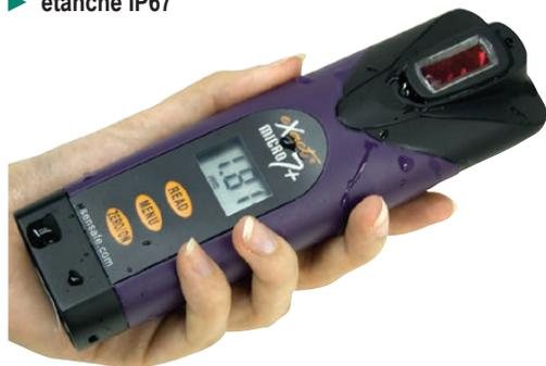
**i** Remplir la cuve intégrée dans le photomètre avec l'eau à analyser, plonger la bandelette pendant 20 s dans la cuve et lire le résultat sur l'affichage digital.
