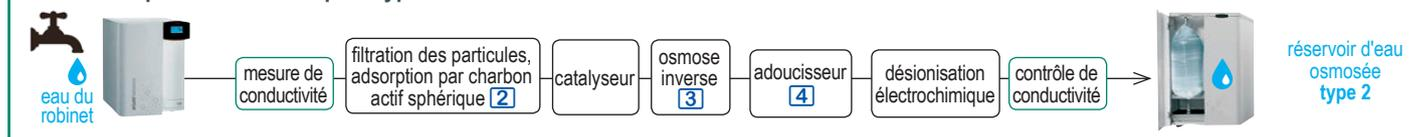
cartouche de pré-traitement au charbon actif pour l'élimination du chlore, des ions et des particules
