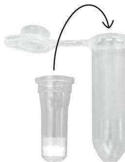
**i** Pour la filtration, l'ultrafiltration et la purification de biomolécules.
