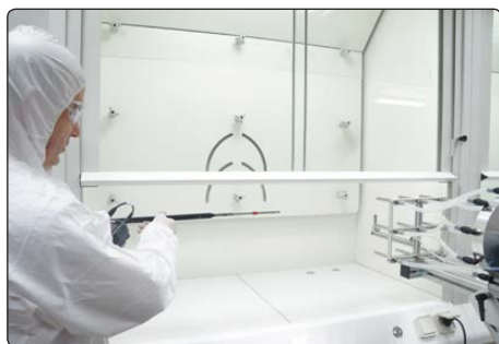
Réalisation du test de confinement par injection du traceur SF6
